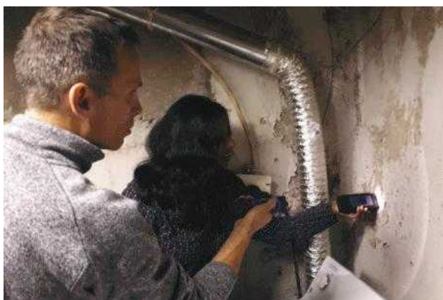
Sharmalene Mendis-Millard, propriétaire, travaille avec son évaluateur pour tenter de déterminer la source des niveaux élevés d'humidité intérieure dans son sous-sol. Waterloo, 2018.
